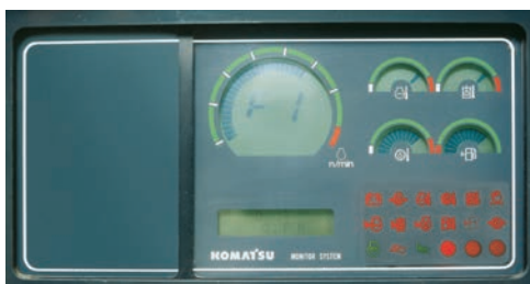
Все лампы аварийной сигнализации и контрольные лампы на панели текущего контроля включены для обеспечения лучшей наглядности фотографии
