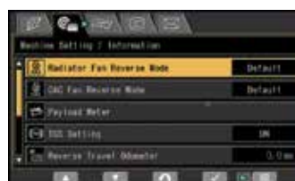
Индикатор обратного вращения вентилятора
